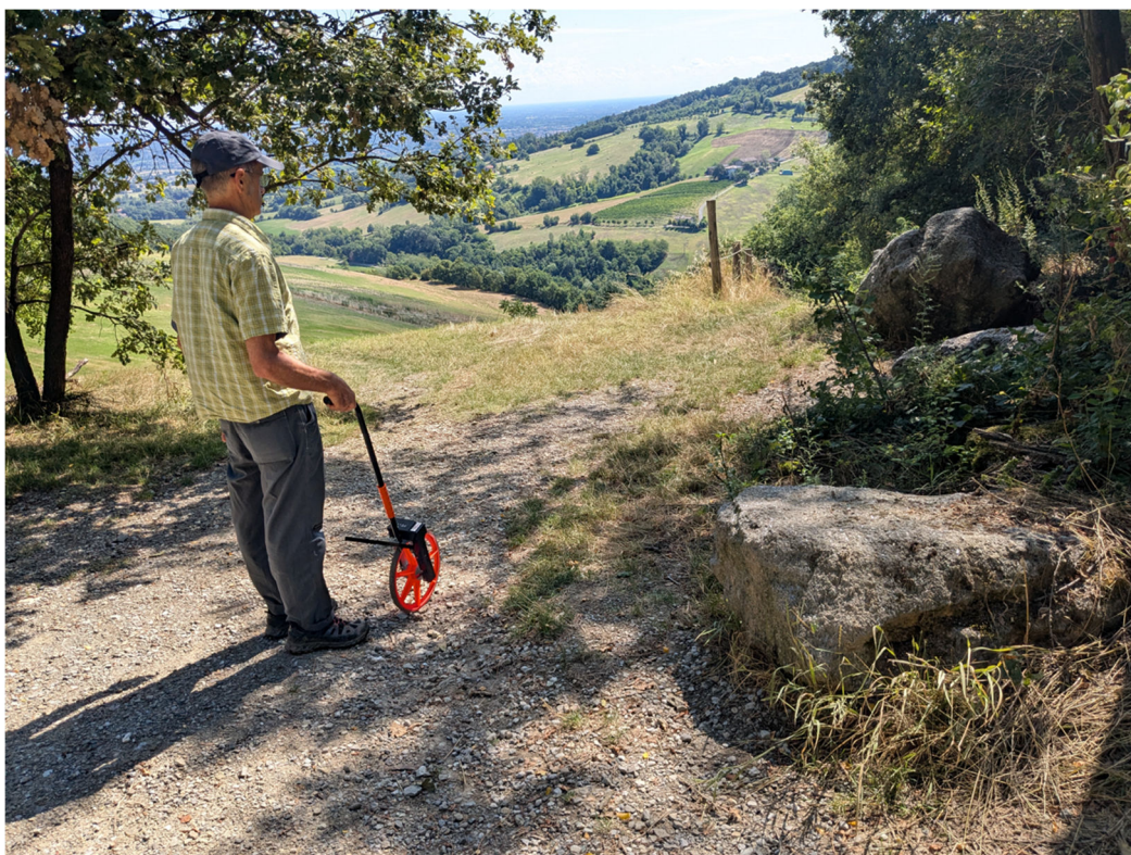
Foto 1 – Progressiva 0,0m; alla Prog.10,0m inizio staccionata con fune (pali diam.12cm – interasse 1,50m – h=90cm.)
