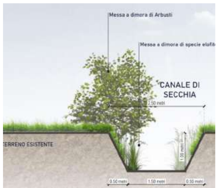
Figura 66 - C2 - Potenziamento della fascia riparia e incremento delle specie elofitiche nel Canale di Secchia
